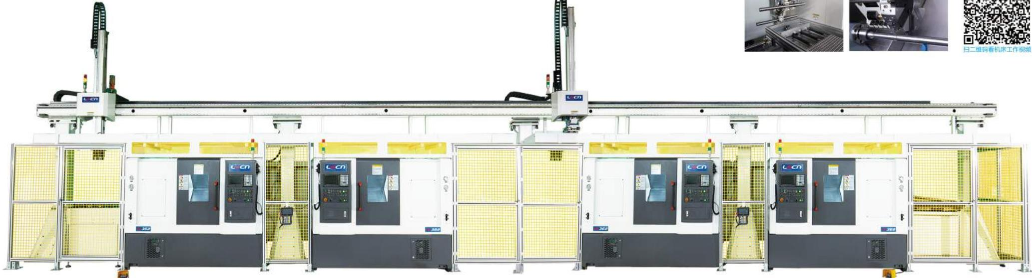
铣端面钻中心孔机床+数控车床+桁架式机器人
