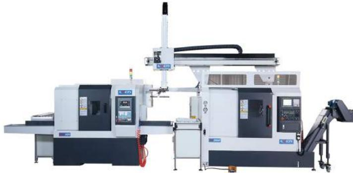
铣端面钻中心孔机床+数控车床+桁架式机器人
