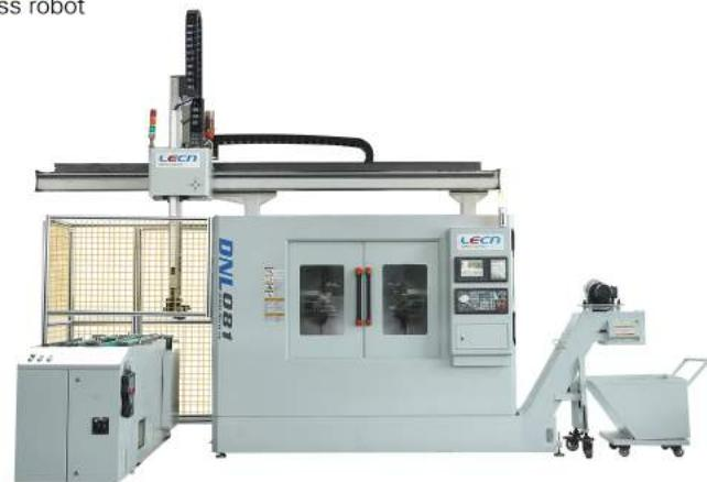
双头数控车床+桁架式机器人
