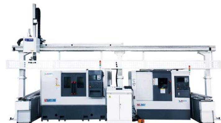
双头数控车床+关节式机器人
