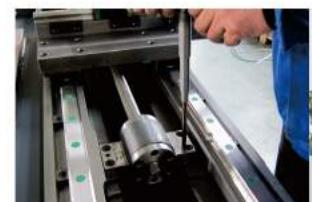
7. X, Z轴均采用双螺母滚珠丝杠和精密的丝杆专用轴承，滚珠丝杠以双轴的方式固定并实施预拉伸，确保输送稳定性及热胀后精度保持性。
