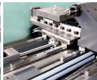
6. NL系列车床X,Z轴均安装有线性导轨，配合精密丝杆可实现快速移动速度24m/min,减少了非切削时间，提高了生产效率。
