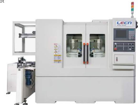
保持架窗口磨床+桁架式机器人
