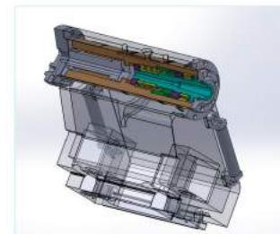
4.主轴式的自旋转尾座，在高速旋转的同时提供最具刚性的部件支撑。
