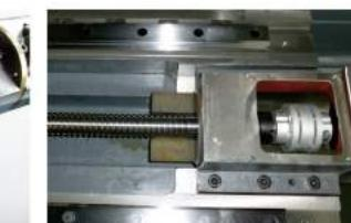
8.伺服电机均通过精密联轴器进行直连，可优化因载荷引起的输送精度变化。
